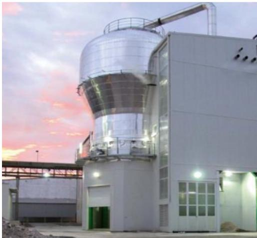
Image 5 : Enceinte de séchage vapeur à lit fluidisé
